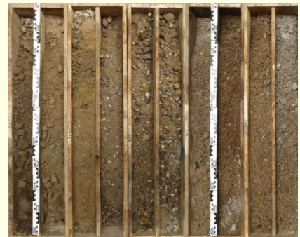
Die entnommenen Bohrkern geben Informationen über den Aufbau des Untergrundes.
